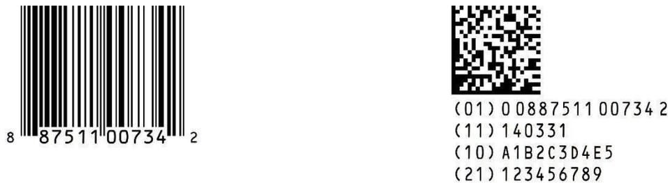
그림 4.3.4-3: GTIN-12 를 인코딩한 EAN/UPC 바코드와 동일한 GTIN-12 를 14 자리 형식으로 변환하고 유통기한/제조번호/ 일련번호 데이터를 함께 인코딩한 GS1 DataBar 바코드
