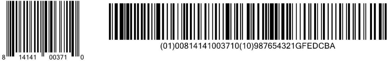
그림 4.3.4-2: GTIN-12 를 인코딩한 EAN/UPC 바코드와 동일한 GTIN-12 를 14 자리 형식으로 변환하고 생산일자/제조번호/ 일련번호 데이터를 함께 인코딩한 GS1 데이터 매트릭스 바코드
